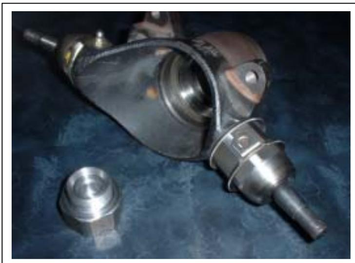
スイベルハブとボールジョイントの間に挟みこんで使用します。試作段階では20mm・30mmを作りましたが30mmでは全体のバランスが悪く不都合箇所も有った事と、20mmで十分な物理的效果が得られたために20mmで製作しました。
