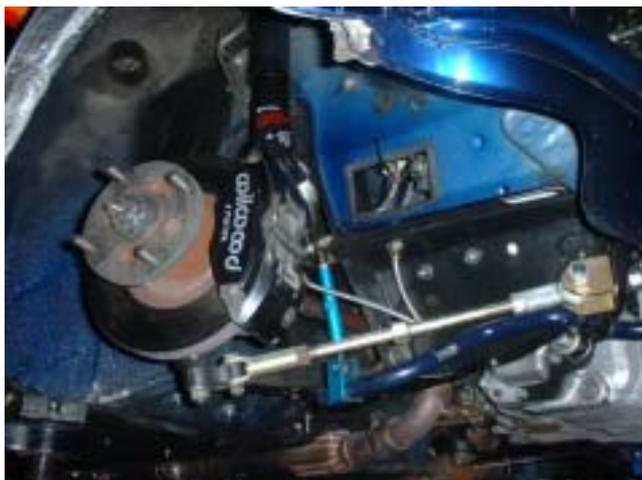
ブレーキはウィルウッド 4 ポット、通称 F4 キャリパーに ERA 用ベンチを加工使用・リヤブレーキも強化しています。
